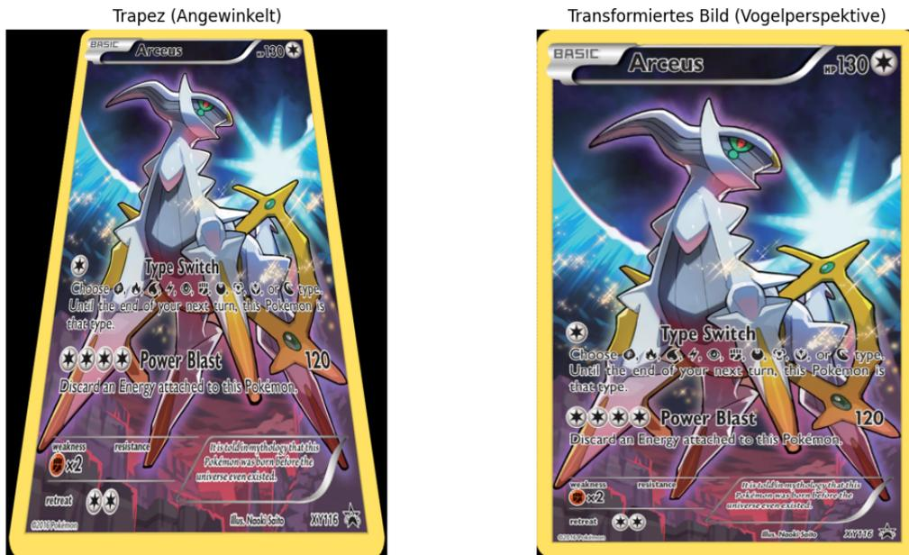
Abbildung 2.6: Durchführung des Homografieverfahrens
