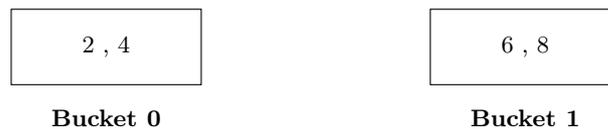
Abbildung 2.15: Speicherlayout beim linearen Sondieren: Überlauf aus Bucket 0 wird in Bucket 1 eingefügt.
